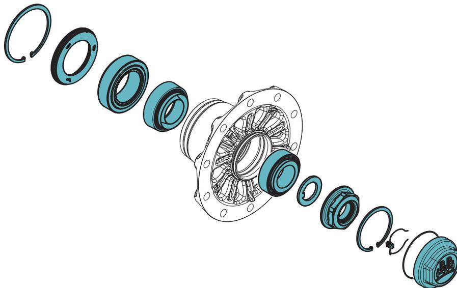
**09.801.08.41.0****Reparatursatz Kegelrollenlager ohne Achsmutter und Kapsel**
