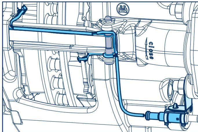
Der neue Verschleißsensorsatz mit der Sachnummer 05.801.49.50.0 ist abwärtskompatibel und jederzeit nachrüstbar und löst den bisherigen Sensorsatz mit der Sachnummer 05.801.50.49.0 ab.
