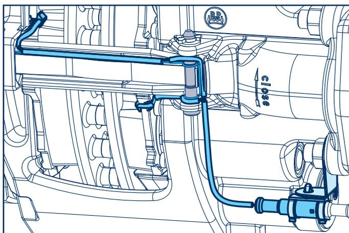
Le nouveau kit de capteurs d'usure portant la référence 05.801.49.50.0 est compatible avec l'ancien matériel et peut être installé à posteriori. Il remplace le kit de capteurs actuel avec la référence 05.801.50.49.0.
