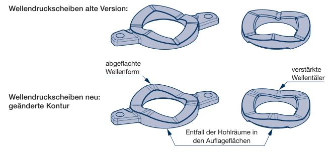
Mit Optimierung der o.g. Wellendruckscheiben und dem nicht mehr zulässigen Einzelaustausch wurden gleichzeitig die Wellendruckscheiben 03.128.05.06.0 und 03.128.05.07.0 gesperrt und sind ab sofort nicht mehr einzeln erhältlich!
