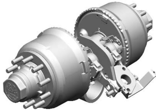
Die integrierte Drehmomentbegrenzung verhindert außerdem die Fehlbedienung beim Anziehen und sorgt für eine optimale Lagervorspannung. Beim Abziehen der Nabe verbleiben die Kegelrollenlager gut geschützt vor Schmutz und Feuchtigkeit in der Nabe. Aber auch ein Austausch der Lagerung ist durch die weltweite Verfügbarkeit der DIN-ISO-Kegelrollenlager kein Problem.
