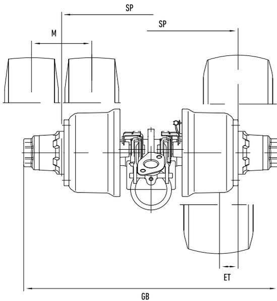
**BPW PENDELACHSEN FÜR BEREIFUNG 15" BIS 24"**
