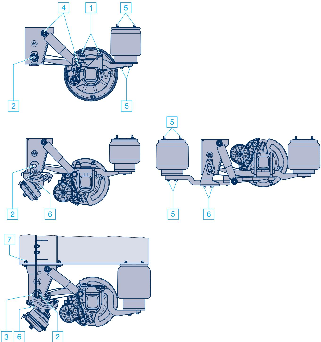
**В случае эксплуатации на дорогах и эксплуатации на бездорожье агрегатов ECO Plus (согласно строкам 7 и 8 таблицы „необходимые характеристики комплектации“) нет необходимости в дотягивании болтовых соединений указанных в таблице на стр. 16–17 для соответствующего случая применения пневматической подвески.**
