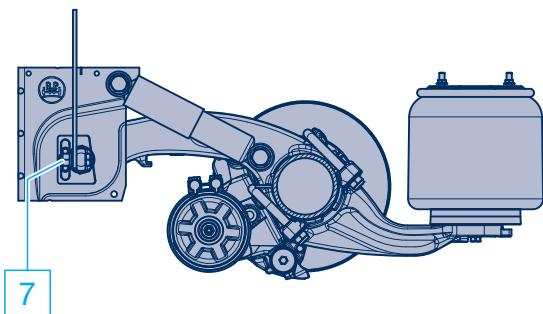
**Двухстороннее устройство подъема оси**
