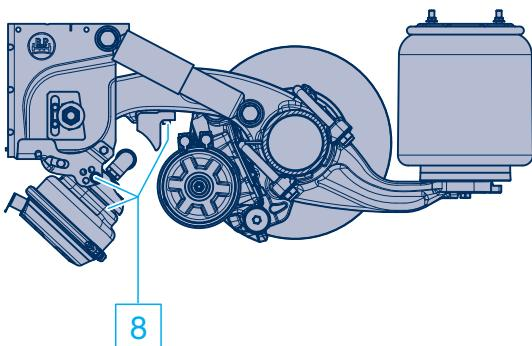
**Одностороннее устройство подъема оси**
