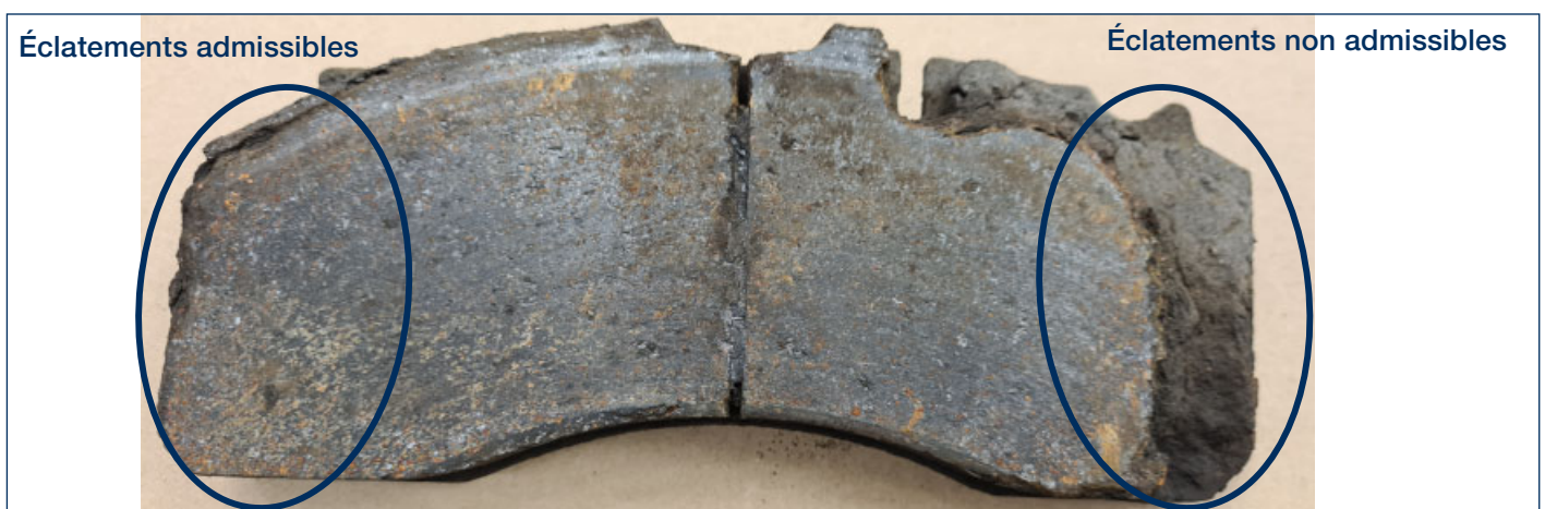
Illustration 3 : Garniture avec éclatements non admissibles
