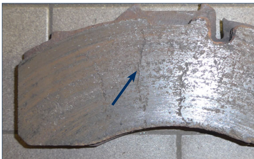
Illustration 4 : Fissures à la surface de la garniture dans une zone admissible
