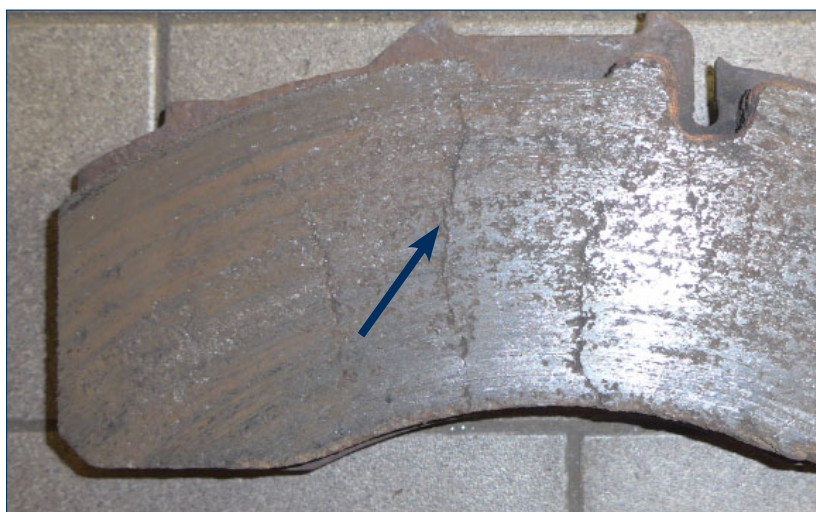
Bild 4: Risse in der Belagoberfläche im zulässigen Bereich
