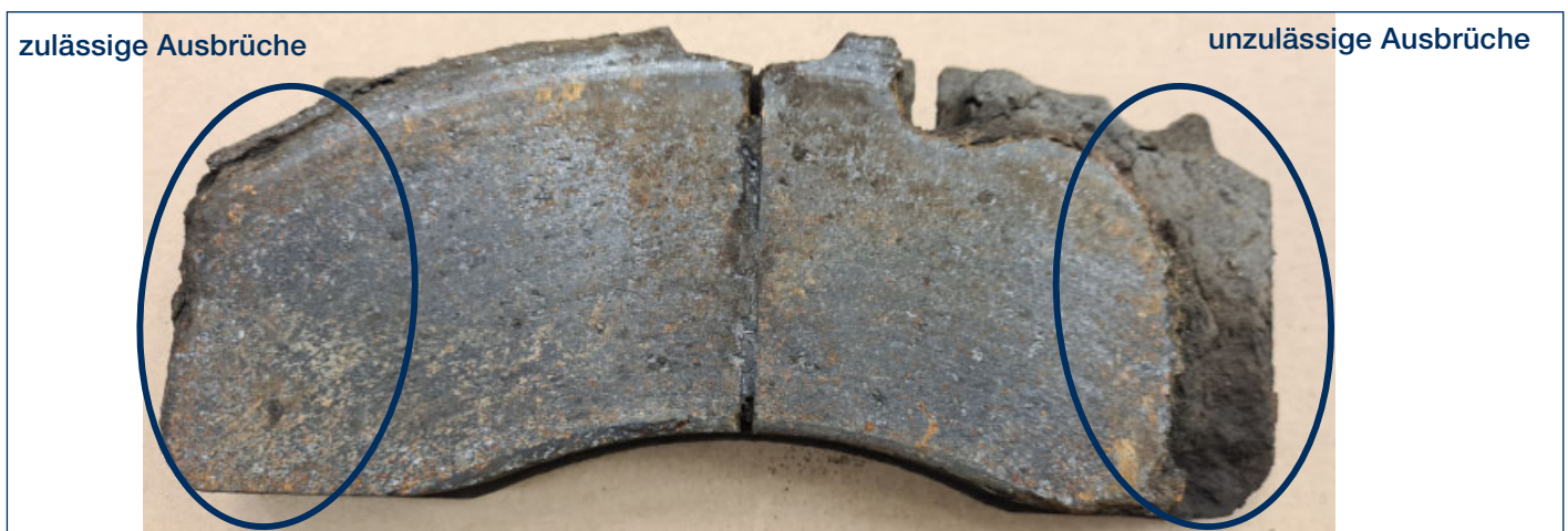
Bild 3: Belag mit unzulässigen Ausbrüchen
