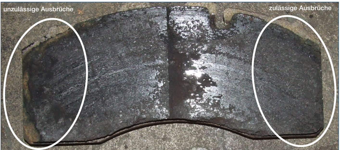
Bild 3: Belag mit unzulässigen Ausbrüchen
