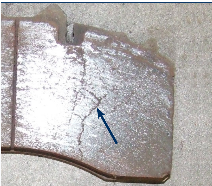
Bild 4: Risse in der Belagoberfläche im zulässigen Bereich
