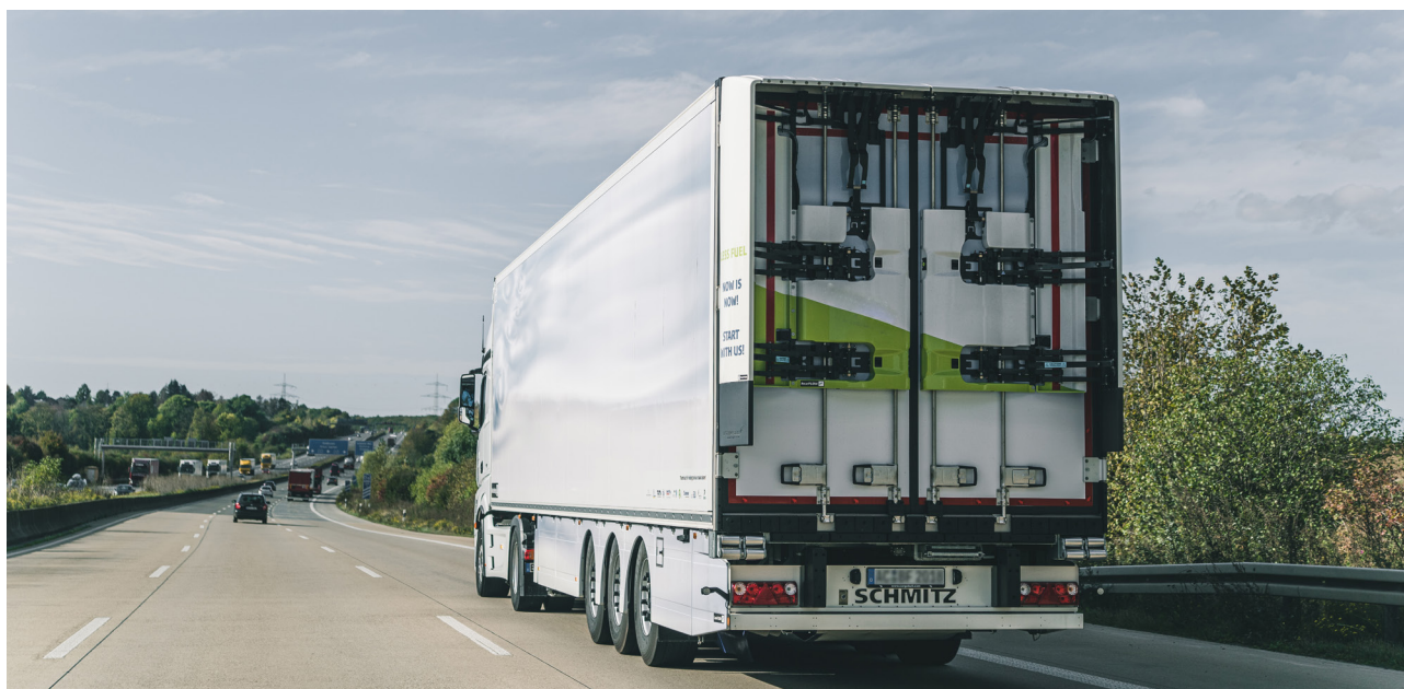
Durch eine verbesserte Aerodynamik sinkt der Kraftstoffverbrauch von Sattelzügen. Quelle: Betterflow
