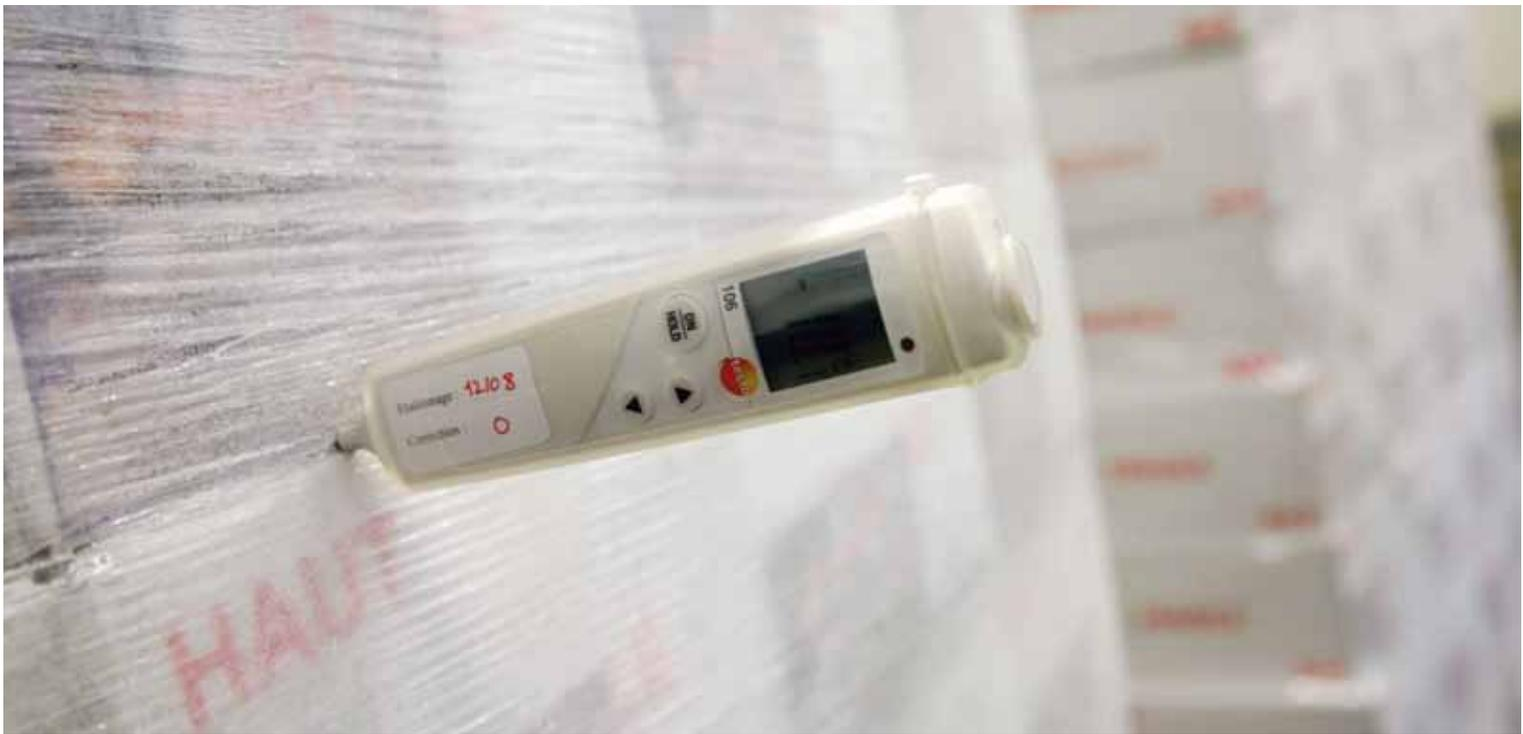
**Qualitätskontrolle bei der Warenübergabe mit dem Thermometer: Wenn das Ladegut hier schon nicht mehr kalt genug ist, kann das während des Transports selbst dann nicht mehr korrigiert werden, wenn das Kühlaggregat mit voller Kraft läuft.**
