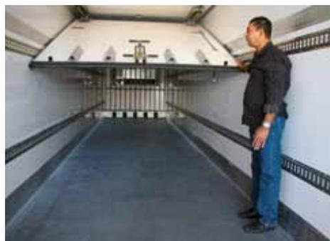
Eine klappbare, verschiebbare Trennwand ermöglicht unterschiedliche Klimazonen.
