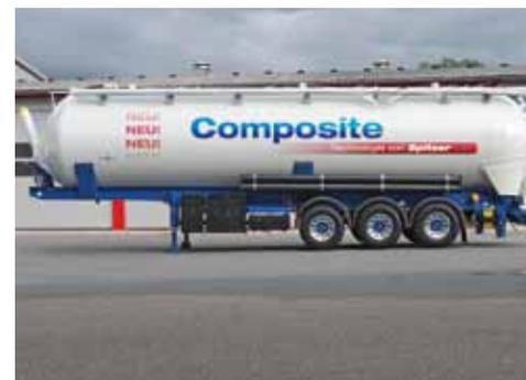
Durch Carbon-Verbundstoff werden Silofahrzeuge leichter.
