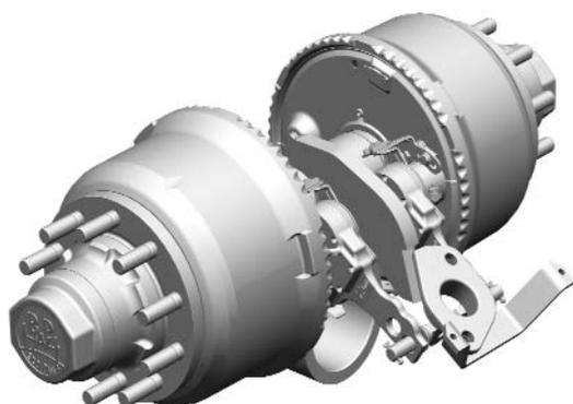
Le dispositif de limitation de couple intégré interdit en outre les erreurs de serrage et garantit toujours une précharge optimale des roulements. Au démontage du moyeu, les roulements à rouleaux coniques restent idéalement protégés contre les salissures et l'humidité à l'intérieur de celui-ci. En cas de nécessité toutefois, leur remplacement est également possible sans problème, les roulements à rouleaux coniques DIN-ISO étant disponibles dans le monde entier.
