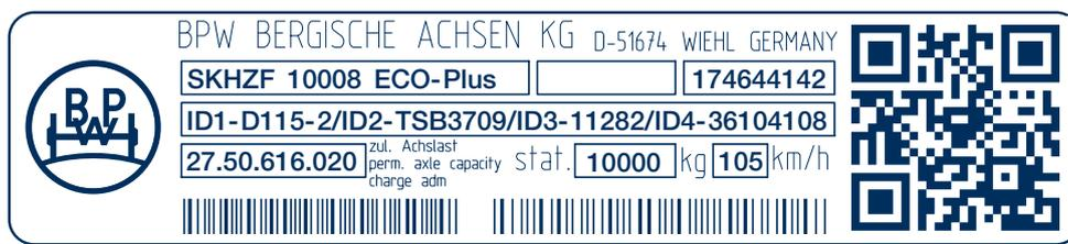
Durch Scannen des QR-Codes mit herkömmlichen mobilen Endgeräten wie Tablet oder Smartphone ist das Auffinden der richtigen Ersatzteillisten, Werkstatthandbücher sowie Montage- u. Bedienungsanleitungen sekundenschnell möglich.
