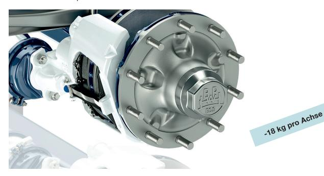
Bestehende Achsen können bei Bedarf auf die Aluminium Naben umgerüstet werden. Die Aluminium Nabe ist für Zusatzlackierung geeignet.
