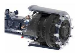
Der Bremsbelagservice erfolgt nach bekannter BPW-Methode ohne Demontage des Antriebsmotors.
